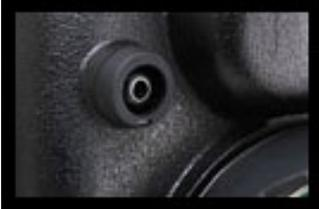
水中の臨場感をとらえる高音質水中マイクロフォン（コンデンサータイプ、モノラル）を装備。
